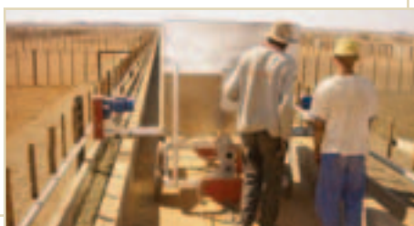
Die voertrollies versprei die voer eweredig in enkele minute oor die totale vreespasies
